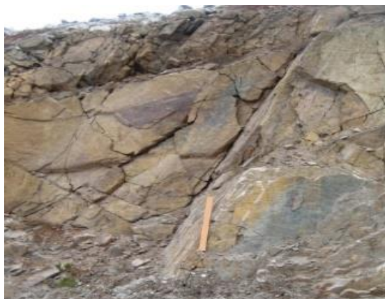
Рисунок 3.13 - а) трещиноватость горного массива в бортах карьере и б) подземных выработках
